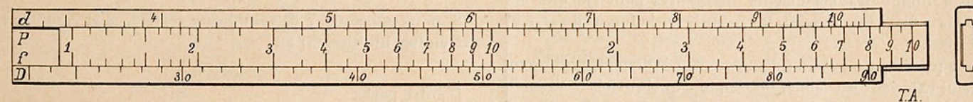
Fig. 3. — Vue de la règle disposée pour les calculs ordinaires.
