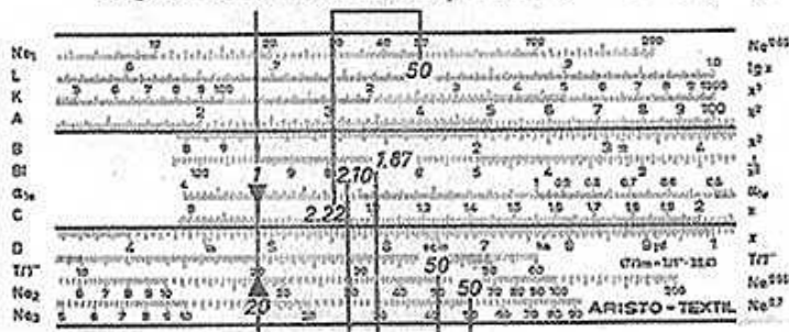
Fig. 10 Calcul de \alpha_{1e} pour une torsion donnée.
